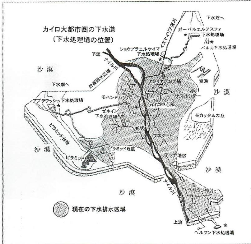
Fig.8 カイロ大都市圏の下水道施設 (右岸、流集して処理し、最終的には処理水、汚泥とも沙漠緑化に使われている)
