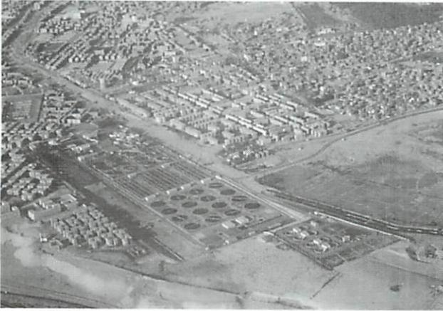
Fig. 11 ベルカ処理場の空中写真(右側に 53ha の汚泥乾燥床が広がる。処理水は 2 万 ha に灌漑されているという) (2002. 5. 30.)
