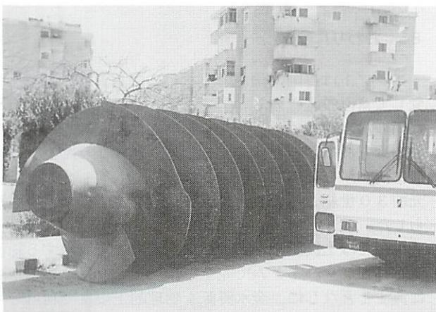
Fig.9 スクリューポンプ軸の本体
